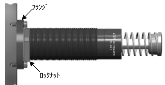
図2A - フランジ(前側)による設置
